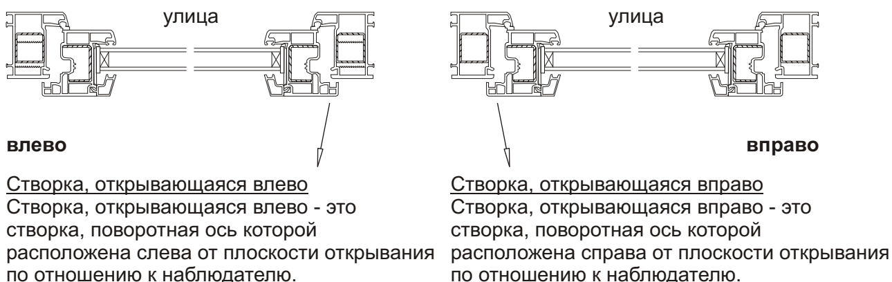
Рис. 7: Определение способа открывания створки по DIN 107
